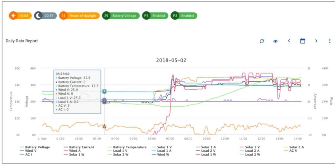
Todo el sistema se puede controlar completamente de forma remota y ajustar a través del software Illumience basado en la nube Clear Blue, que incluye parámetros de carga, compensación de temperatura, prueba y solución de problemas del panel solar remoto, control remoto de emergencia, perfiles de iluminación y más.
